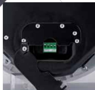
Connecteur de type Phoenix à 4 contacts
